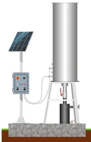
È la soluzione più semplice ed economica per la combustione in sicurezza del biogas da discarica e quando le emissioni dei gas combustibili non sono soggette a particolari regolamentazioni. Collegata alla rete di convogliamento del biogas captato dai pozzi di captazione è provvista di separatore scaricatore di condensa in ingresso.
