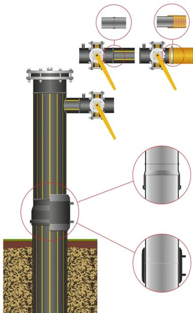
Utilizzata per la chiusura definitiva o provvisoria di pozzi biogas ottenuti per trivellazione o per crescita progressiva durante le fasi di coltivazione della discarica. Consente la captazione, regolazione e convogliamento del biogas prodotto dalla discarica.
